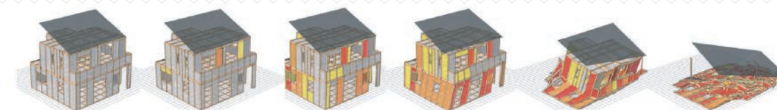
▲新耐震 2000 年基準（仕様規定）の住宅が阪神・淡路大震災の地震動で倒壊するまでの過程
